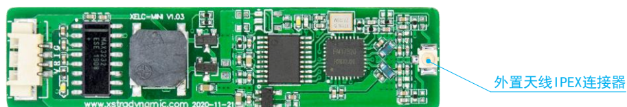
图 2.2 外置天线接入示意图
