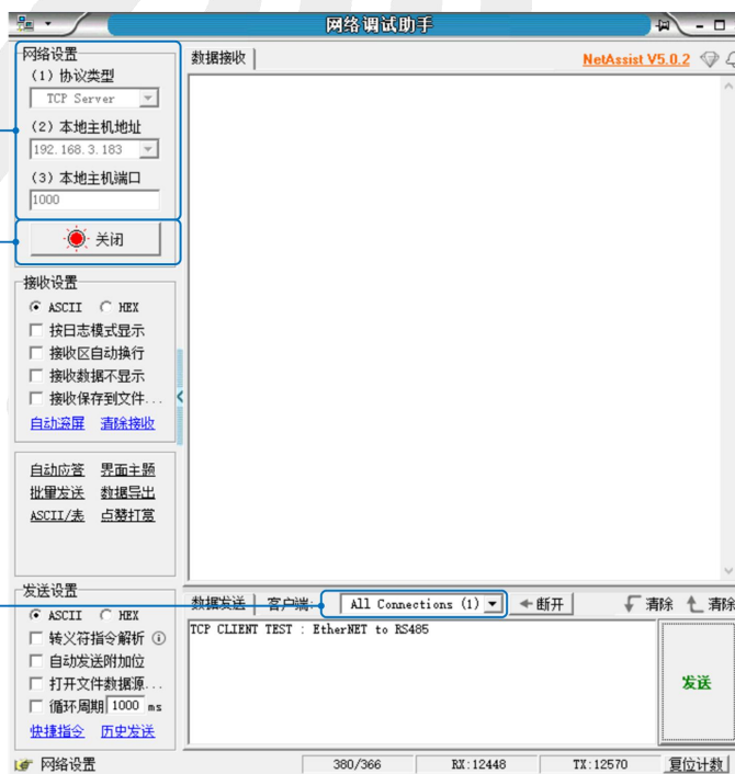
图 2.6 PC 端网络调试助手设置
